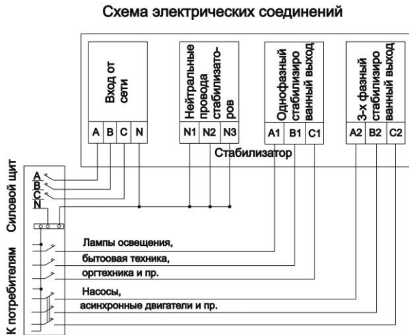
Рисунок 2 – Схема подключения к трёхфазной сети стабилизатора со стойкой
